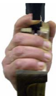
Los dedos no están centrados en el gatillo. La palma de la mano tiene muy poco espacio en la empuñadura.
