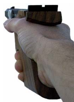
Fijación lateral trasera demasiado gruesa
